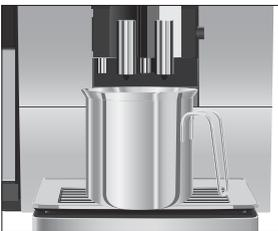
Es fließt mehrmals Wasser direkt in die Restwasserschale sowie aus dem Heißwasser- und Kombiauslauf.
