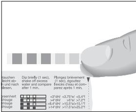
Während der ersten Inbetriebnahme müssen Sie die Wasserhärte einstellen. Kennen Sie die Wasserhärte des verwendeten Wassers nicht, können Sie diese zunächst ermitteln. Verwenden Sie hierfür das im Lieferumfang enthaltene Aquadur®-Teststäbchen.
